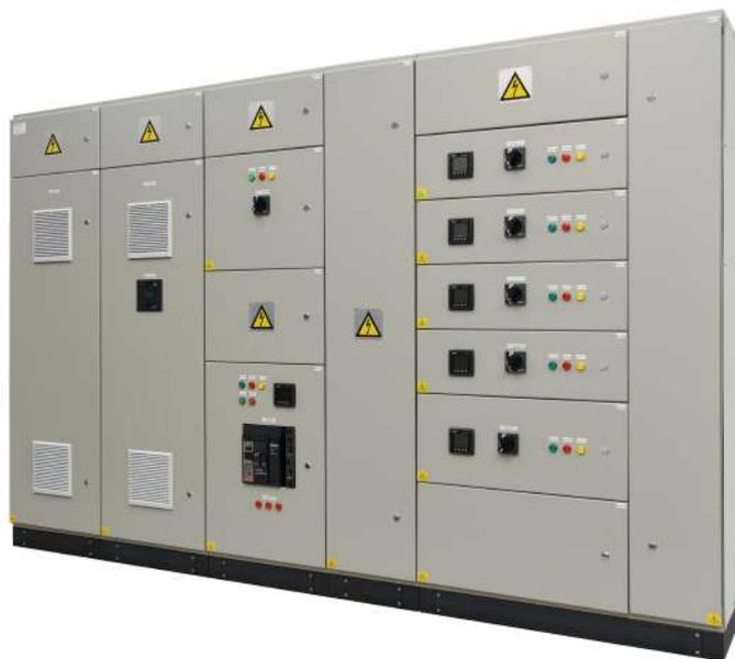
Cada compartimiento alberga en su interior los componentes correspondientes a una salida de motor o máquina, permitiendo realizar tareas de puesta en marcha o mantenimiento sin necesidad de interrumpir la alimentación del resto del conjunto. **Esta característica es clave en entornos industriales donde se prioriza la operatividad continua y la seguridad en la intervención.**
